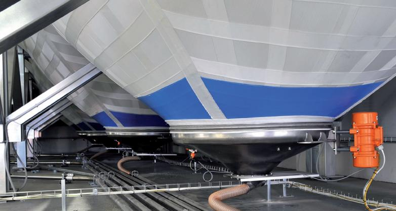
Silos modulari per interni in acciaio dotati di letto fluido per lo svuotamento uniforme e totale del prodotto.
